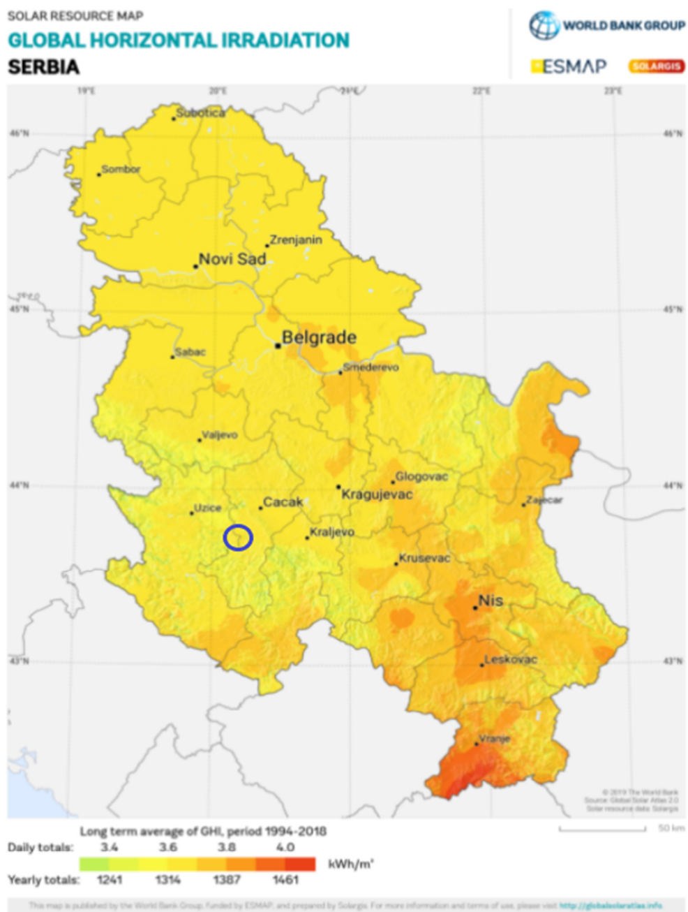
Slika 4.5.4. –Prikaz globalnog horizontalnog solarnog zračenja za širi region ciljne lokacije u Arilju (naznačeno plavim krugom)
